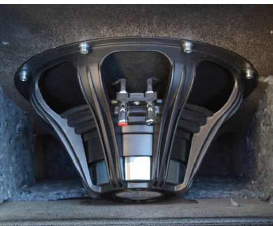
Wnętrze obudowy HBP12HP kryje neodymowy 12-calowy przetwornik firmy FAITAL PRO, o średnicy cewki 4”.
