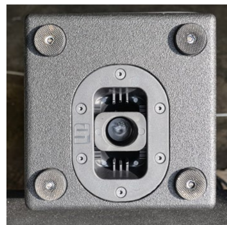
Na dolnej ścianie obudowy DA46 zamontowano cztery gumowe nogi oraz gniazdo statywu o zmiennym kącie nachylenia. Dzięki temu zestaw można zarówno postawić na podłożu, jak i na statywie czy sztycy.
